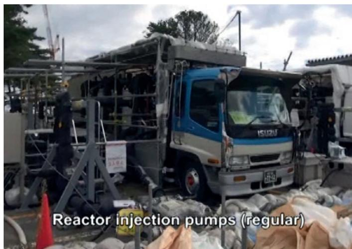
Abb. 6.1: Reaktoreinspeisepumpen und Ersatzaggregate (Quelle: TEPCO Video).
